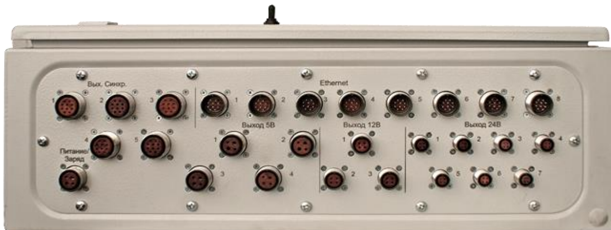
Рис. 6 – Нижняя панель коммутационного шкафа ИВК «Центрифуга»
